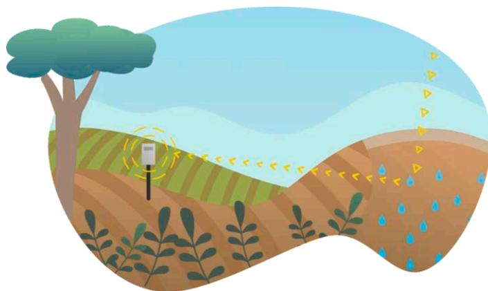
Figura 2. La sonda Finapp misura i neutroni formati dall'interazione tra i raggi cosmici e l'acqua.
